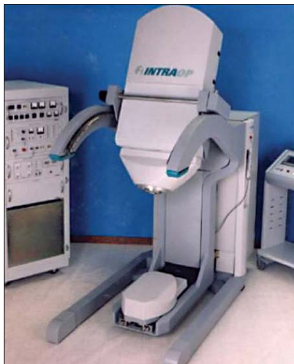
Rycina 6. Mobetron — aparat do radioterapii śródoperacyjnej za pomocą elektronów (do 12 MeV)
